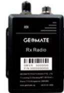
4. Während der Installation müssen Sie PORT3 des Originalmonitors herausziehen und in den Kabelbaum des Funkmoduls einstecken, und dann den Kabelbaum des Funkmoduls in PORT3 des Monitors einstecken, um die Installation abzuschließen
