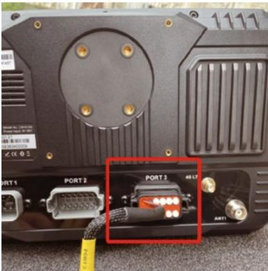
(2) Stecken Sie den Kabelbaum, der in den PORT3 des Monitors eingesteckt werden soll, in den Kabelbaum des Funkmoduls
