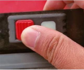
Halten Sie die rote Abschaltsicherung fest und drücken Sie sie in die entgegengesetzte Richtung des Wippschalters, um das Navigationsgerät der Landmaschine auszuschalten.
